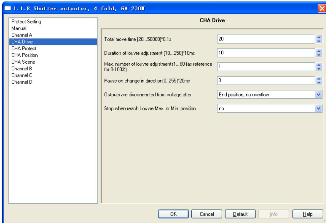
Fig.5.4 parameter window “CHA Drive”
